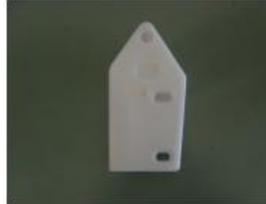
Haube PP zu Hochstromkontakt 3000 A von Schlötter
