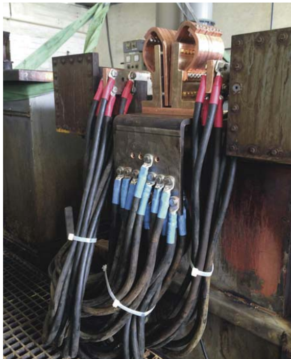
Saubere Kontaktstellen garantieren eine optimale Schichtdickenverteilung und verlustfreie Stromübertragung. (Bilder: ERNE surface AG)
