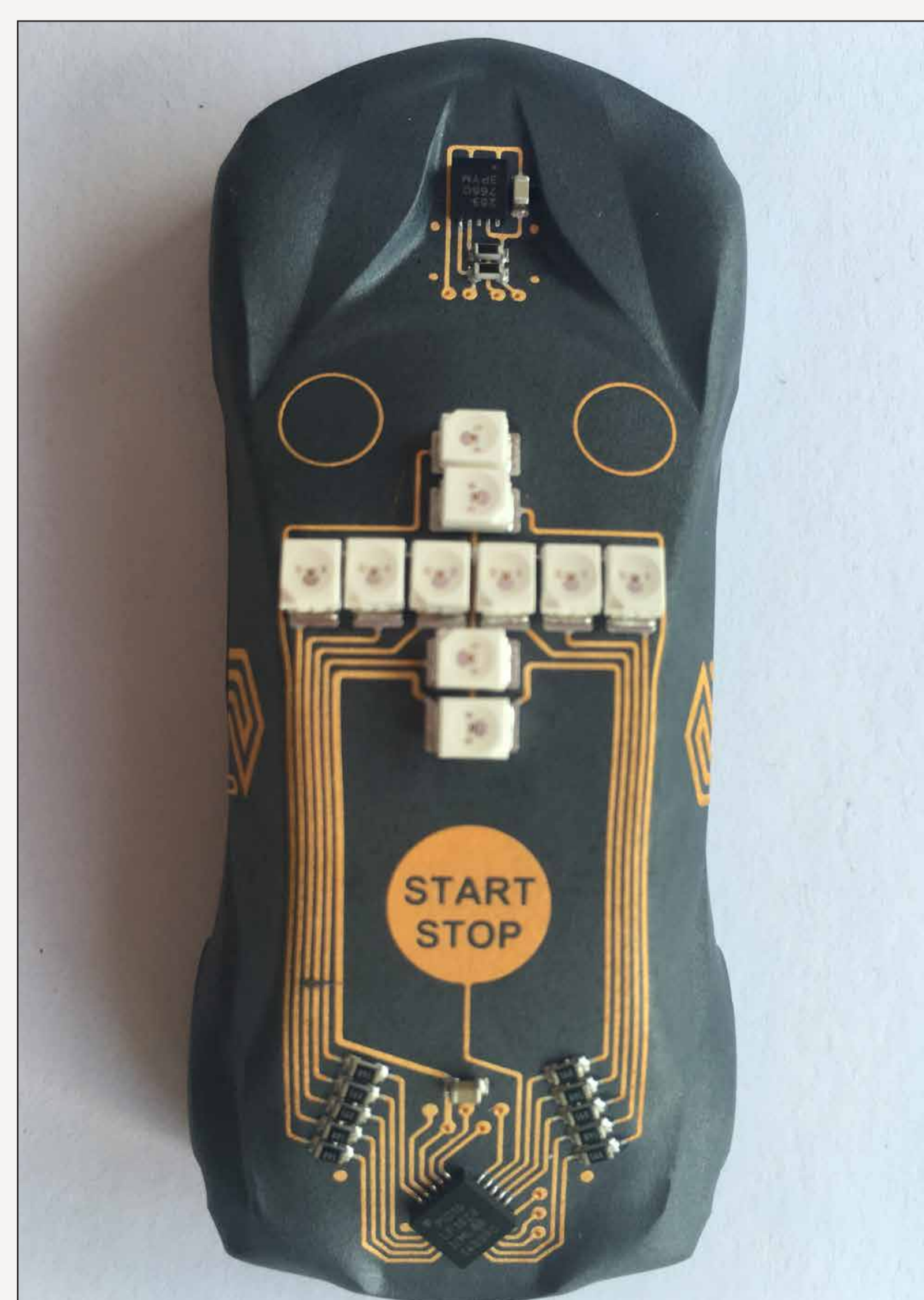
MID (Molded Interconnect Devices, engl. für: spritzgegossene Schaltungsträger)-Modell zur Darstellung aller möglichen Funktionalitäten (2014)
